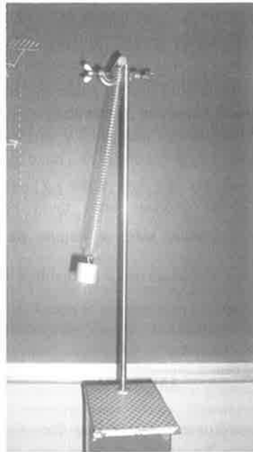
СЛИКА 4: Демонстрациони оглед за нелинеарне хармонијске осцилације. Маса тега је изабрана тако да је приближно једнака резонантној маси m_r = kl_0 / (3g) .
